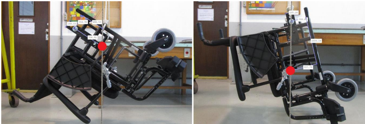
Figure 22 – Experimento para obter centro de massa da cadeira de rodas.
