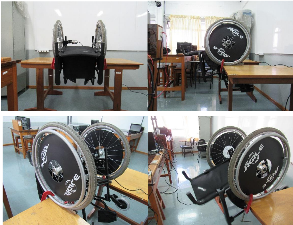
Figure 32 - Oscilação da cadeira de rodas
