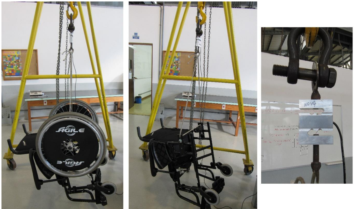
Figure 26 – Medição da massa da cadeira de rodas
