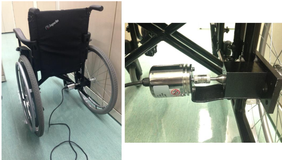
Figure 27 – Cadeira de rodas instrumentada com tacômetro.
